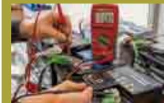
Überprüfung der Ruhespannung nach den jeweiligen Test-Durchläufen
